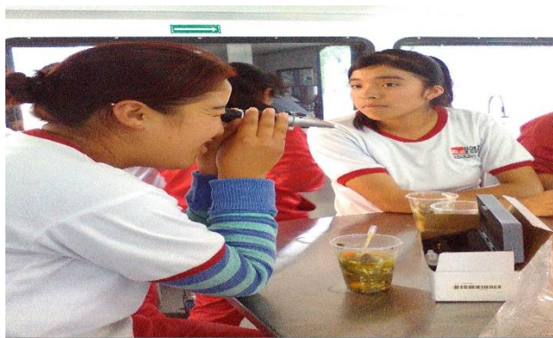
Fotografía 6. Medición de grados Brix a chiles en escabeche.
